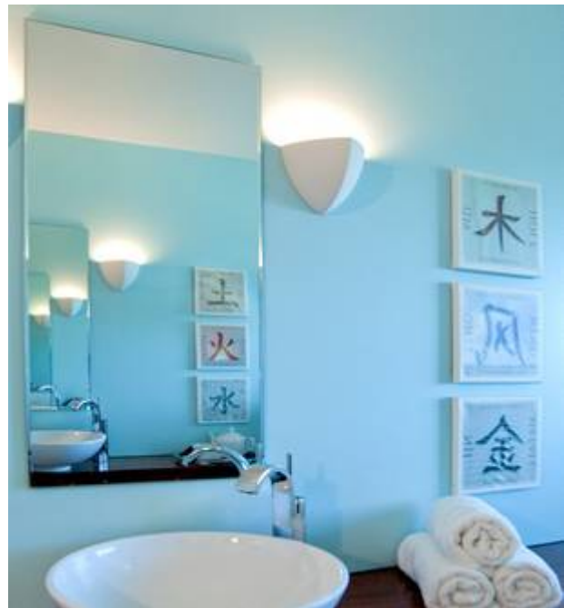
Abb. 6 Kunst (Bilder) auf Akustiktextil zur Schallabsorption
